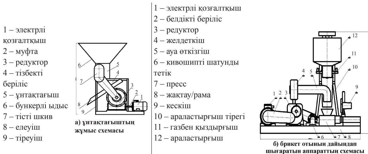
Сурет 1. АШПШ пайдаланып брикет отынының үлгісін дайындаудың технологиялық жүйесінің макеті
