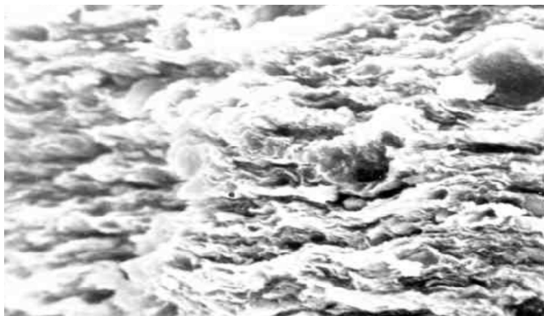
Рисунок 1. Структура ФК из высококачественной глины (снимок среза ФК на сканирующем электронном микроскопе)
